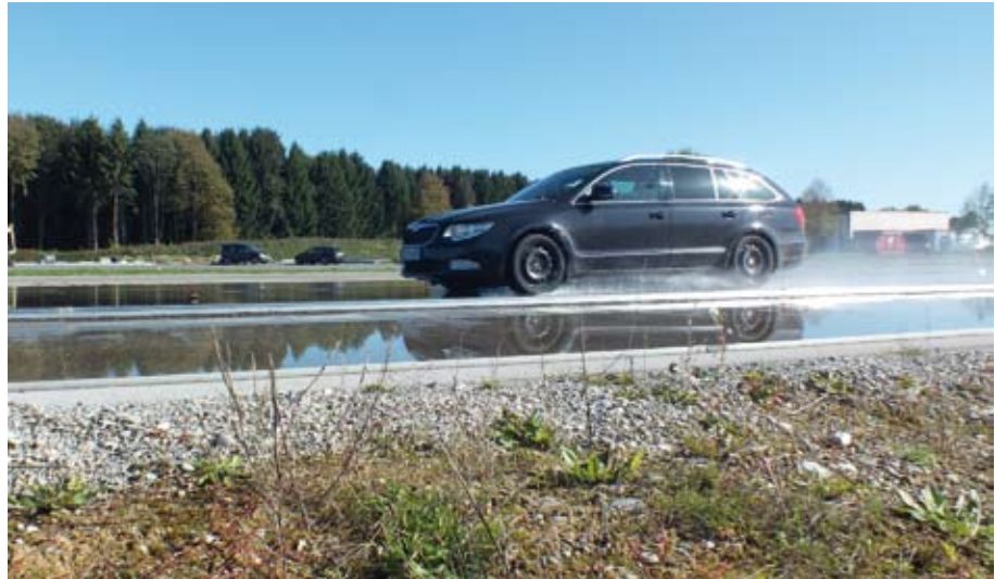
Nach Entnahme der Stichprobe von Reifen, die hinsichtlich des Reifenlabels geprüft werden sollen: Nasshaftungstest mit Testfahrzeug auf der Teststrecke.
