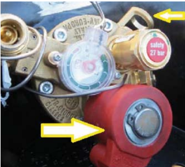
Abb. 2: Muss nicht ausgetauscht werden – BRC-Multiventil vom Typ Europa2.
