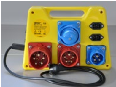
Abb. 7.1 Prüfadapter für Prüflinge mit Steckvorrichtungen, wie CEE-Norm 3~/400V/50 Hz oder 3~/200V/300 Hz o. Ä., die nicht direkt an ein herkömmliches Prüf-/Messgerät anschließbar sind.
