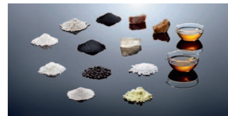
Die verschiedenen Inhaltsstoffe eines Reifens.
